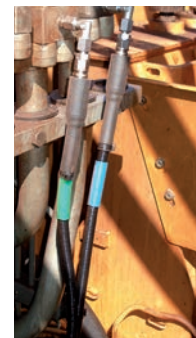
6 Nyomásjeladó, az emelési nyomás méréséhez
